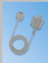
**Anschlusskabel 15-polig steckbar**, Verbindungskabel 2m, eine Seite mit 15-poligem Spezialstecker, andere Seite mit Klemmenadapter, zum einfachen Ankleben der Anschlusskabel zu den externen Komponenten (Alarmleuchte, Signalgeber, RS 232/485-Schnittstelle, Stromausgang, Alarm-Meldekontakte, Stromversorgung), Gehäuse IP 54, Klemmverschraubung M20, Abmessungen ca. 65 x 40 x 80 mm
