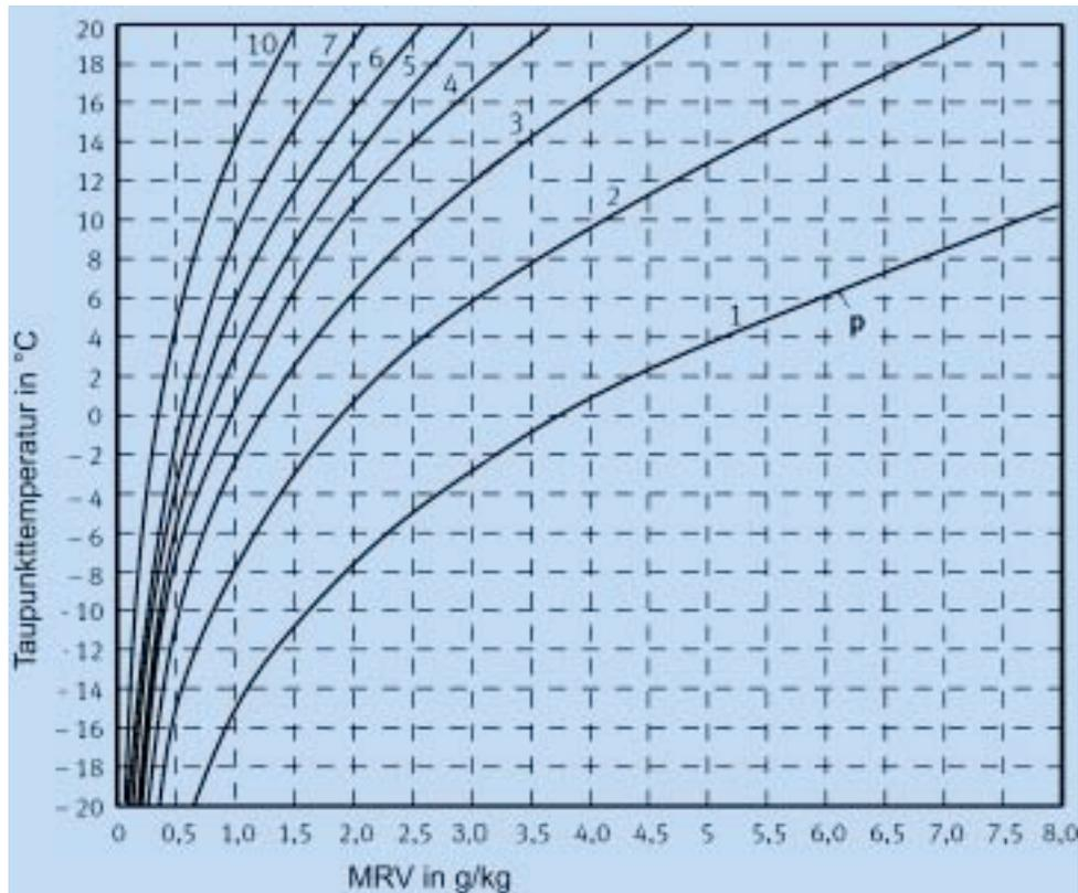
Um den absoluten Feuchtegehalt (z. B. MRV) der Luft zu bewerten, ist es daher oft von Vorteil, den Taupunkt im komprimierten Gas (bei höherem Druck) zu messen. Bedingt durch das Messprinzip der eingesetzten kapazitiven Polymersensoren lassen sich so genauere Messwerte erzielen, als bei Vermessen der expandierten Luft.
