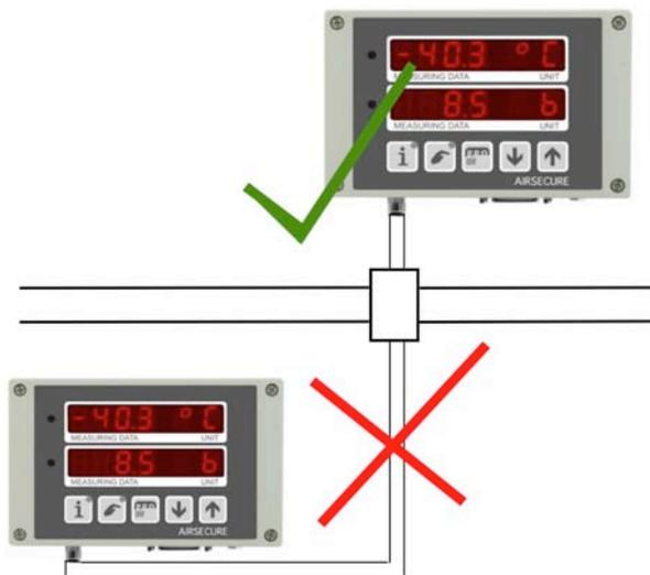
Um Ansammlung von Kondensat im Fehlerfall zu verhindern, muss der Anschluß des Gerätes von oben senkrecht in die Leitung eingeschraubt werden.
