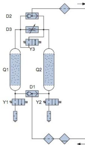
Der Trockner besteht aus zwei Trockensäulen (Q1 und Q2), die wechselseitig im Betriebs- oder im Regenerations-Zustand sind. Die Patrone, die von Druckluft durchströmt wird, trocknet diese und nimmt das in der Luft enthaltene Wasser auf. Die zweite Patrone wird währenddessen in reverser Richtung von expandierter, trockener Luft durchströmt und dadurch getrocknet. Nach einiger Zeit werden die beiden Säulen vertauscht und der Trocknungsvorgang mit der zuvor regenerierten Säule fortgesetzt.
